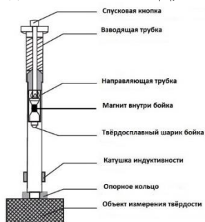
Датчик динамический тип Д, схема
